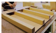
4 下板の取り付け
