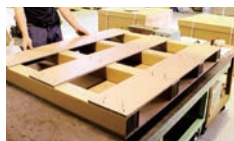
5 下板取り付け後
